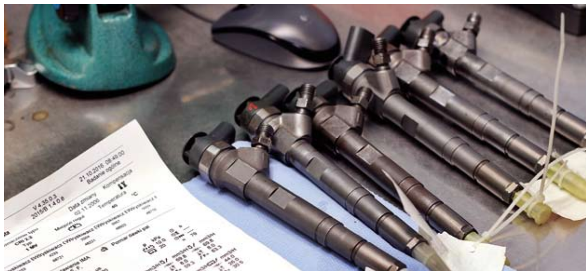
Poprawnie zmontowany wtryskiwacz, aby opuścić fabrykę firmy Lauber, musi przejść szczegółowe testy
